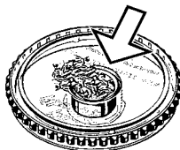
Dosierkapsel beim Befüllen mit Magazineckel (Trichter)
