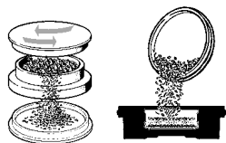
Befüllen der Füllkammer bis maximal zum unteren Trichterrand
